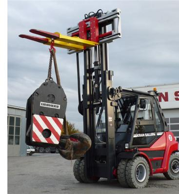
Unser Linde Stapler H 80 mit einer Durchfahrthöhe von nur 2,86 m verfügt über einen Triplexmast mit Freihub und ist mit diversen Anbaugeräten wie z.B. einer Gabelzinkenverlängerung auf 3 m sowie einem Kranarm von Durwen mit einer Tragfähigkeit von 8 t ausgestattet.
