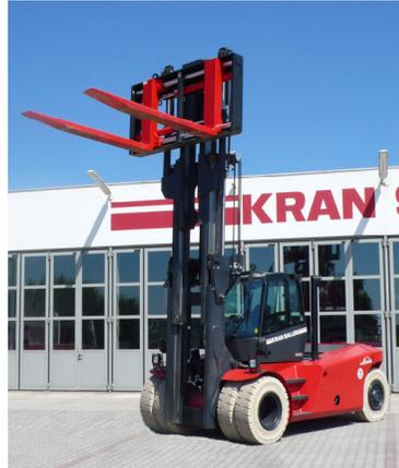
Der Linde Schwerlaststapler H 160 rundet unsere Staplerflotte nach oben ab! Highlight ist unter anderem der Triplexmast, der dem Stapler eine Bauhöhe von nur 3,15 m verleiht und somit einen kostengünstigeren Transport ermöglicht, da keine Demontage des Mastes erforderlich ist. Eine Hubmast- sowie eine Rückfahrkamera erleichtern zusätzlich das Rangieren mit dem 27,5 t schweren Stapler. Nicht zu vergessen sind die nicht kreidenden Reifen, die in der 16 t-Klasse einzigartig sind!
