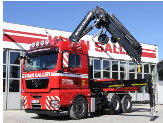
Dank eines Schnellwechselsystems sind die Ballastbrücke und der Ladekran in circa 15 Minuten demontiert. Somit ergibt sich eine klassische Schwerlastzugmaschine mit einem Gesamtzuggewicht von 120 t.
