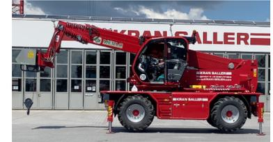
Für das Verheben von schweren Lasten auf große Höhen und über weite Distanzen dienen Ihnen unsere Teleskopstapler mit bis zu 26 m Arbeitshöhe. Mit diversen Anbausätzen sorgen diese für einen effektiven und kosteneffizienten Einsatz, vor allem auch im Bereich der Lagerlei.
