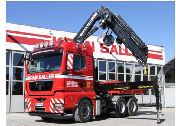
Dank eines Schnellwechselsystems sind die Ballastbrücke und der Ladekran in circa 15 Minuten demontiert. Somit ergibt sich eine klassische Schwerlastzugmaschine mit einem Gesamtzuggewicht von 120 t.
