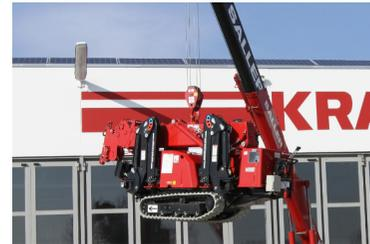
Mit seiner massiven Tragkraft von 2.820 kg kämpft der MC 285-2 in einer höheren Gewichtsklasse, als seine Transportbreite von nur 750 mm vermuten lässt.
