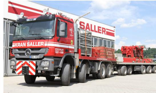
Sonderfahrzeug für Ballastteile, wahlweise mit 3 - 5 achsigem Anhänger für Kranzubehör. Rungensystem variabel steckbar - nutzbar für verschiedene Krantypen. Spezielle Aufnahmen für Kranballast, zur verbesserten Ladungssicherung.
