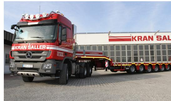
Schwerlastzugmaschine mit verstellbarer Sattelkupplung, wahlweise mit 3 - 6 achsigen Semitiefadlern bzw. mit Tiefbetten kombinierbar, maximal mögliches Zuggesamtgewicht 120 t.
